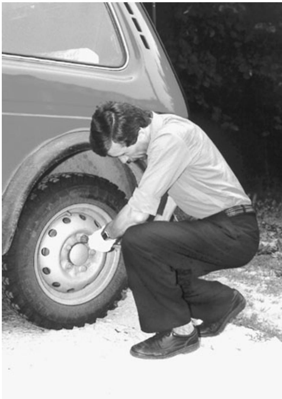
Рис. 10. Правильное положение тела при откручивании гаек колеса
