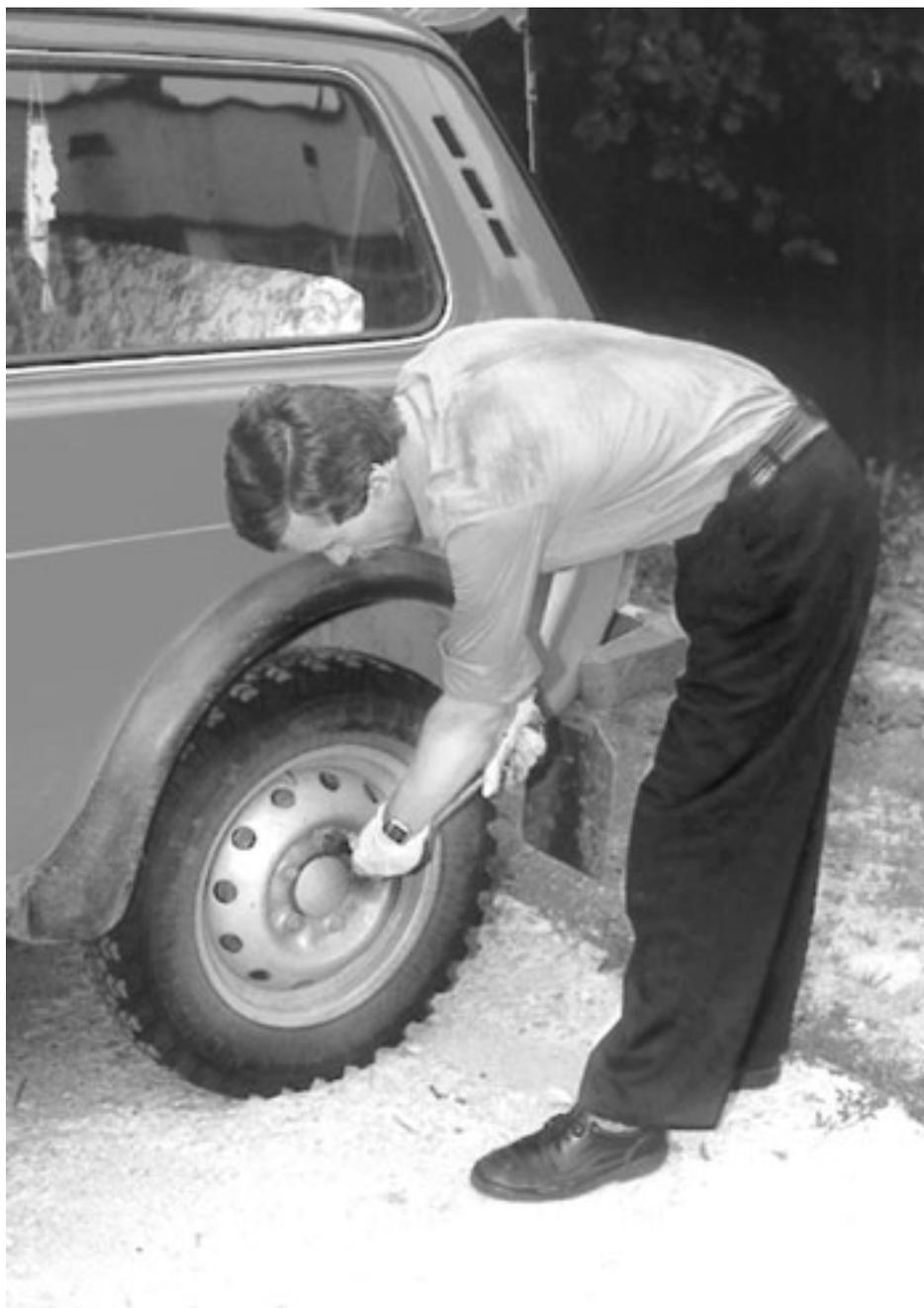
Рис. 11. Неправильное положение тела при откручивании гаек колеса
