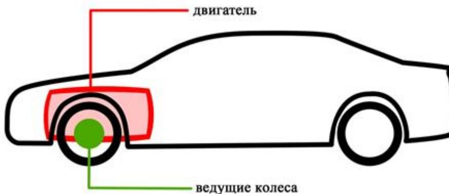
Передний привод означает, что под воздействием двигателя крутятся передние колеса, они одновременно являются ведущими и управляющими (поворачиваются с помощью рулевого управления).
