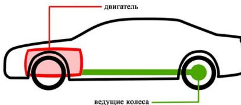
Задний привод означает, что двигатель крутит задние колеса посредством карданной передачи.
