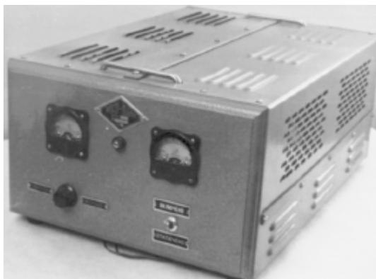
Рис. 1. Блок автоматического регулирования напряжения АРН (МТЗ)
