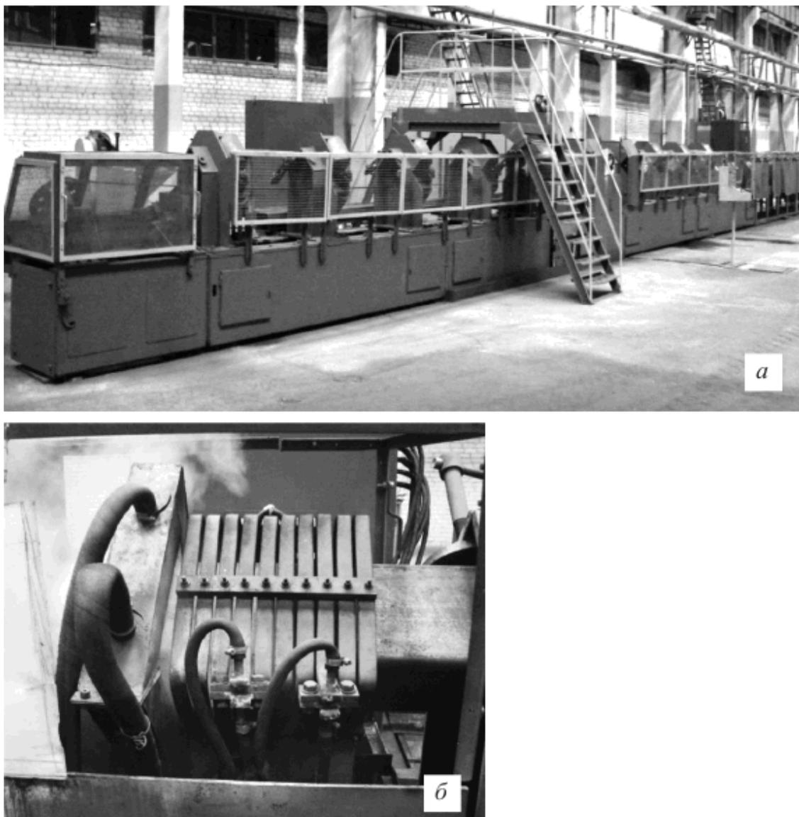
Рис. 5. Общий вид установки (а) и индуктора (б) для закалки балки плуга
