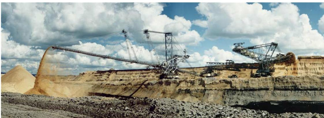
Рис. 1.3. Вскрышные работы комплексом непрерывного действия (разрез «Березовский»)
