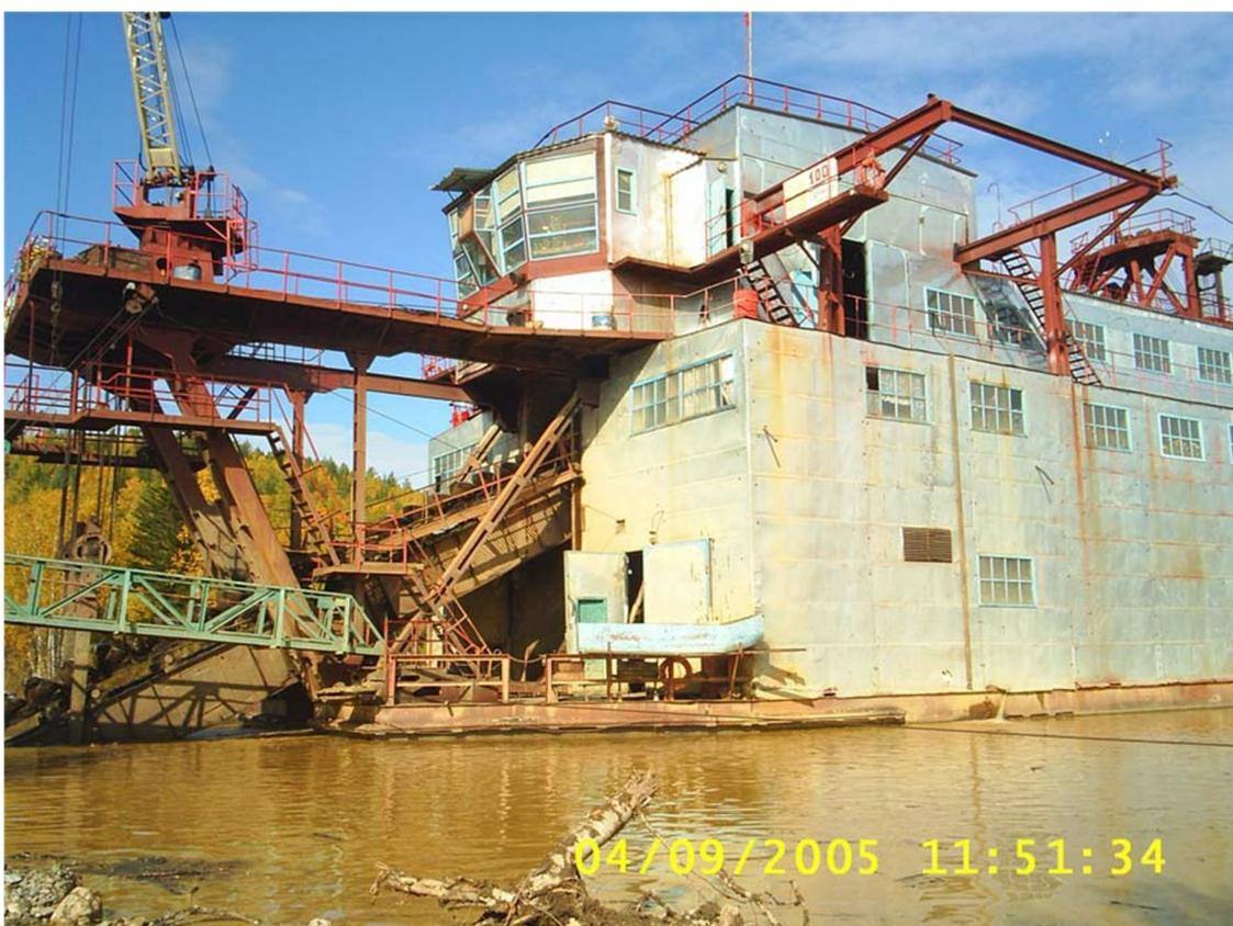
Рис. 1.5. Добыча золота дражным способом
