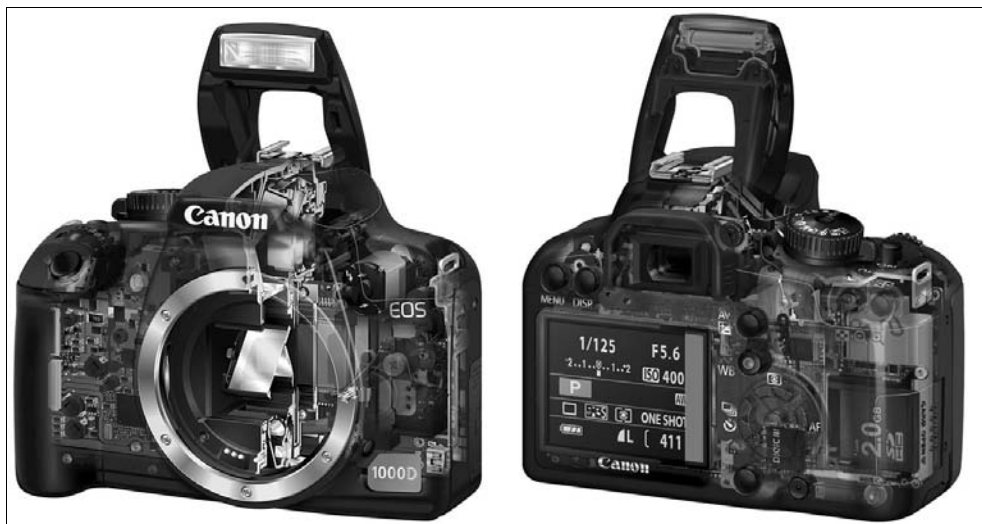
Рис. 1.6. Внутреннее устройство цифровой SLR-камеры
