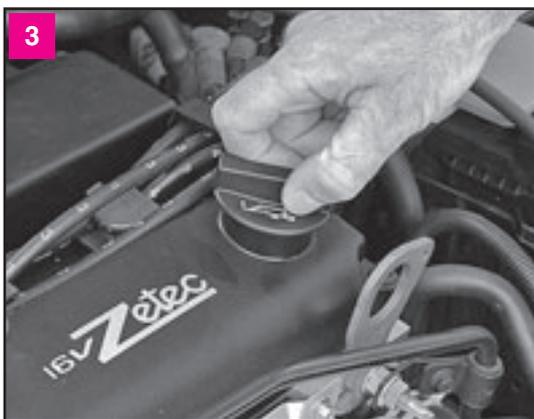
Поворачиваем крышку маслозаливной горловины против часовой стрелки
