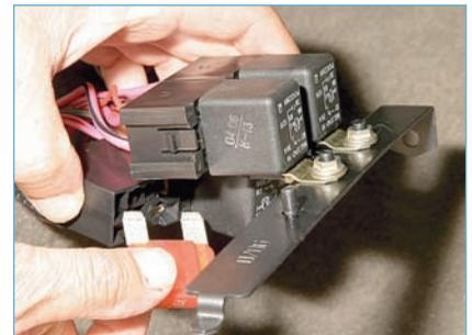
...вынимаем его из колодки блока. Для замены предохранителей системы управления...
