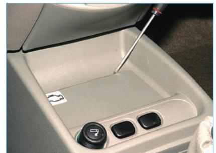
...поддеваем отверткой крышку облицовки туннеля пола...
