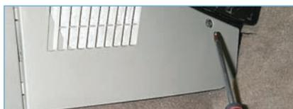
...крестообразной отверткой отворачиваем саморез крепления правой боковой облицовки туннеля...
