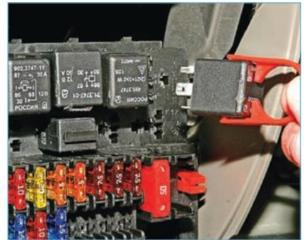
Большим пинцетом извлекаем реле большого размера.
