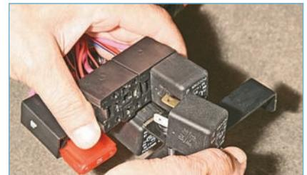
... и вынимаем реле из колодки. Аналогично вынимаем два других реле системы управления. Устанавливаем реле в обратной последовательности. Для замены предохранителя (50 А) электровентилятора системы охлаждения двигателя...
