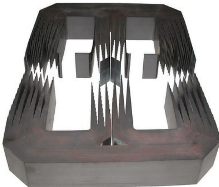
Рисунок 1. Трансформатор 630/6/1,2 собранный с магнитопроводом по технологии UNICORE.
