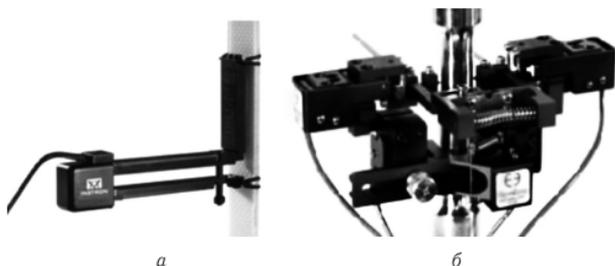
Рис. 1.9. Динамический экстензометр для регистрации осевой деформации (а) и двухосевой экстензометр для измерения осевой и сдвиговой деформации (б)
