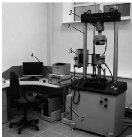
Рис. 1.5. Сервогидравлическая испытательная система Instron 8801: 1 — двухколонная высокоточная рама со встроенными гидравлическими подъемниками верхней траверсы; 2 — электронный датчик нагрузки Dupacell; 3 — 3-зонная высокотемпературная печь SF 1770; 4 — 3-зонный контроллер печи SFL; 5 — контроллер сбора и обработки экспериментальных данных FastTrack 8800
