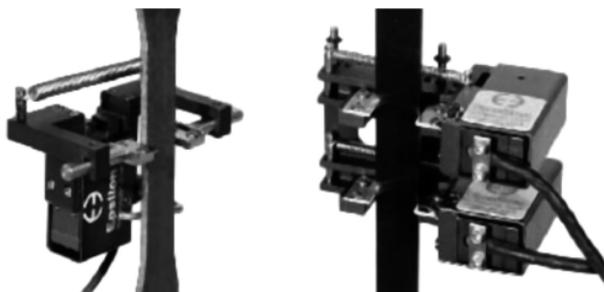
Рис. 1.10. Экстензометры для измерения поперечной деформации
