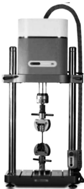
Рис. 1.2. Универсальная электродинамическая испытательная система ElectroPuls E3000
