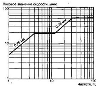
Рис. 79. Предельные значения скорости ветровой нагрузки в основании [11]
