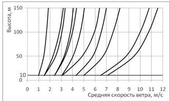
Рис. 76. Средние скорости ветра для различных мест в зависимости от высоты [9]
