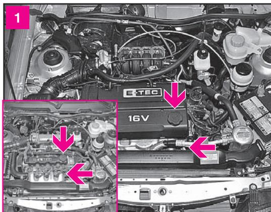
Маслозаливная горловина 16- и 8-клапанного (показан на врезке) двигателей расположена в верхней части мотора с левой стороны по ходу движения автомобиля. Рядом с ней расположен щуп-указатель уровня масла, имеющий ручку с желтым кольцом
