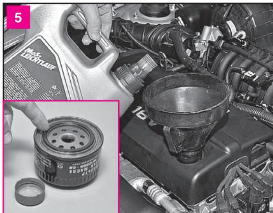
Заполняем фильтр свежим маслом и наносим его на уплотнительное кольцо. Наворачиваем фильтр на его штуцер и плотно затягиваем усилием руки. Заливаем в двигатель 3,75 л свежего масла
