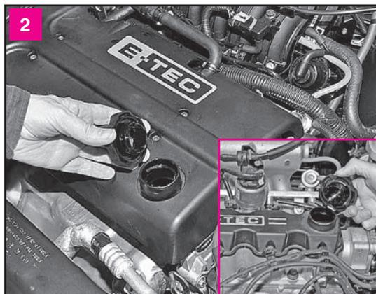
Перед сливом масла отворачиваем крышку маслозаливной горловины против часовой стрелки и снимаем ее
