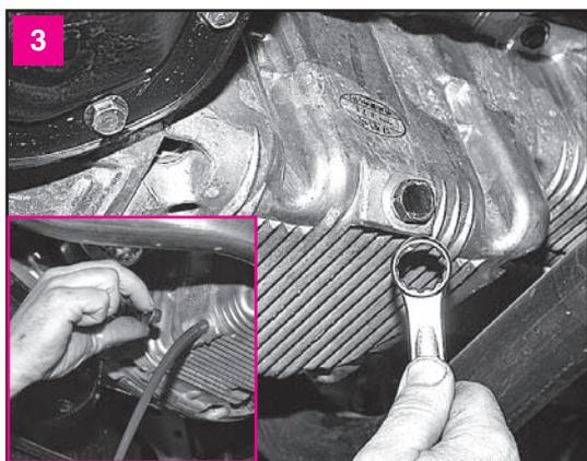
Накидным ключом «на 19» отворачиваем пробку сливного отверстия поддона картера двигателя. Пробка уплотнена медной шайбой. Сливаем масло в течение 10 мин. Очищаем пробку и заворачиваем ее. Поврежденную шайбу заменяем новой
