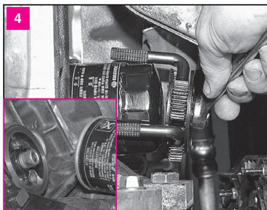
Отворачиваем фильтр вручную или с помощью съемника. Снимаем фильтр (из него может вытечь некоторое количество масла — подставьте емкость). Очищаем посадочное место фильтра от грязи
