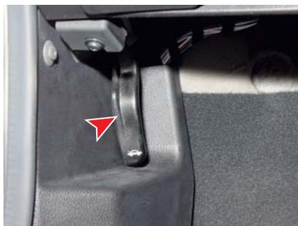
Чтобы открыть капот, в салоне автомобиля тянем на себя ручку привода замка капота, расположенную в нише обивки левой боковины.
