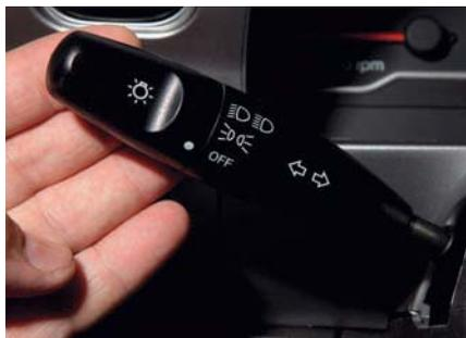
...перемещаем рычаг левого подрулевого переключателя на себя. При отпускании рычаг возвратится в исходное положение.
