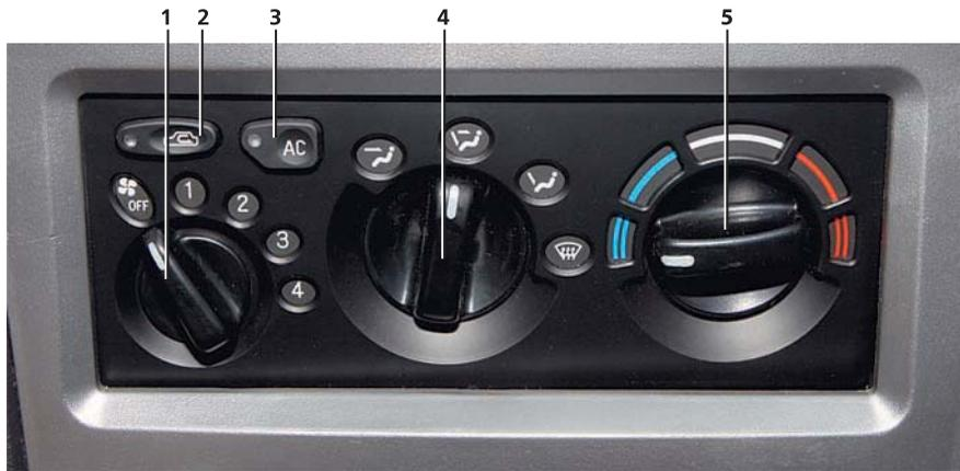
**При включении кондиционера после продолжительной стоянки автомобиля в жаркую погоду на солнце не направляйте поток холодного воздуха на ветровое стекло во избежание образования трещин.**
