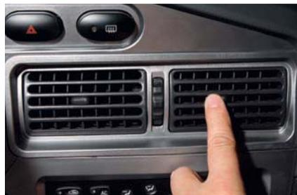
...при помощи рычажка, обеспечивающего поворот направляющих дефлектора...
