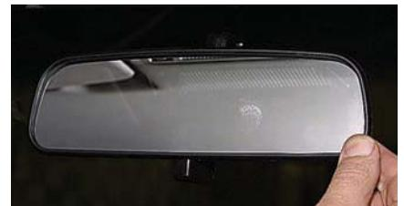
**Положение внутреннего зеркала регулируем, поворачивая его корпус на шарнире.**
