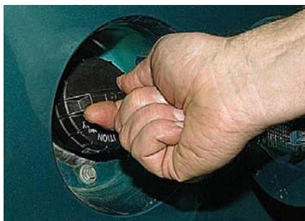
Заворачиваем пробку по часовой стрелке до срабатывания ограничителя.
