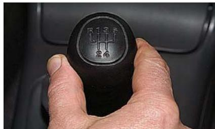
**Схема расположения передач изображена на рукоятке рычага переключения коробки передач.**
