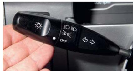
В верхнем положении рычага переключателя включен правый указатель поворота...
