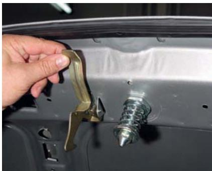
...поднимаем рычаг предохранительного крюка (для наглядности показано на открытом капоте).
