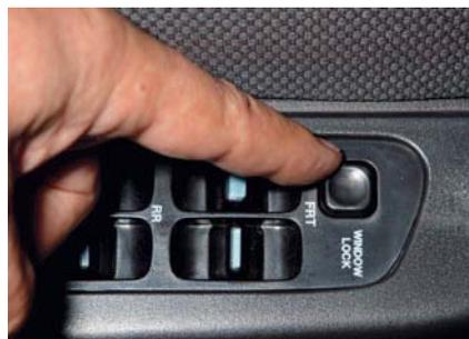
При нажатии кнопки блокировки механизма электростеклоподъемников регулировка положения стекол дверей возможна только с места водителя.
