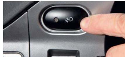
Для включения передних противотуманных фар нажимаем кнопку при включенном наружном освещении.
