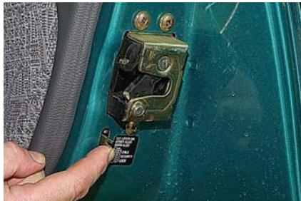
**Переведя фиксатор, расположенный в торце задней двери под замком, в верхнее положение, дополнительно блокируем замок.**
