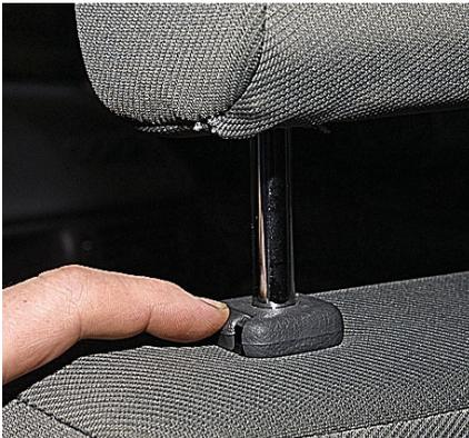
**...нажимаем кнопку фиксатора в левой верхней части спинки сиденья...**
