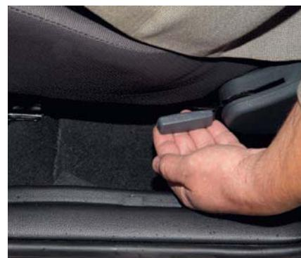
...поднимаем рычаг фиксатора спинки, расположенный сбоку подушки сиденья (со стороны двери)...
