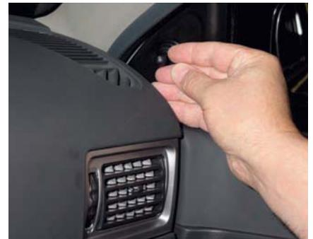
**...перемещаем регулировочный рычаг зеркала до нужного положения.**
