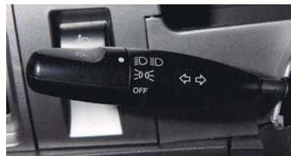
– включены: габаритные огни, освещение номерного знака, подсветка панели приборов, ближний свет фар.
