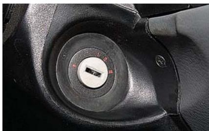
**Положения ключа в замке зажигания:** «В» – «рулевой вал заблокирован»; «I» – «зажигание выключено»; «II» – «зажигание включено»; «III» – «стартер».
