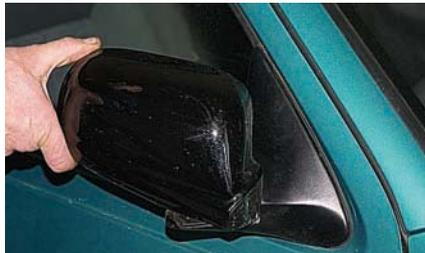
Надавив на зеркало в направлении задней части автомобиля, складываем его.
