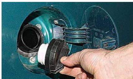
Отворачиваем пробку против часовой стрелки.
