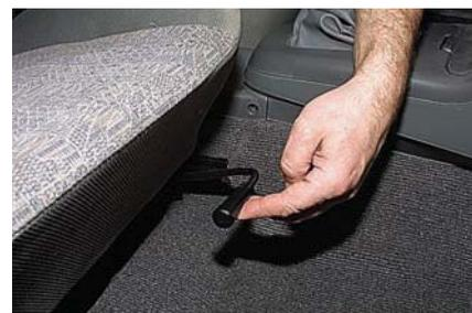
...тянем вверх рычаг фиксатора, расположенный справа под водительским сиденьем (под пассажирским сиденьем – слева)...
