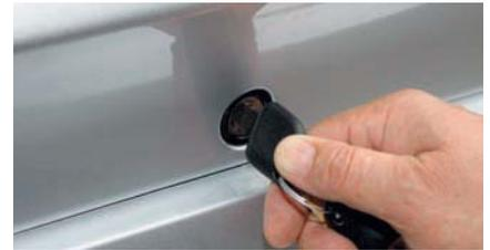
**Вставив ключ в личинку замка крышки багажника, поворачиваем его по часовой стрелке...**
