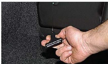
...в правом заднем углу багажника тянем на себя рукоятку запасного привода замка крышки лючка.
