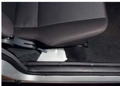
Идентификационный номер (VIN) автомобиля выбит под ковровым покрытием на полу кузова между правой передней дверью и пассажирским сиденьем.
