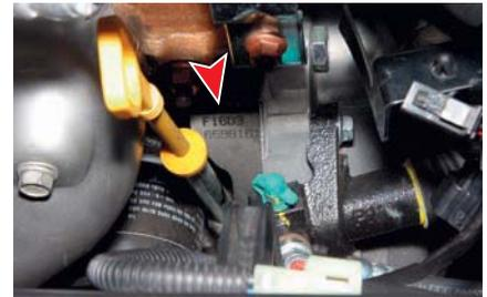
Номер двигателя выбит на передней стороне блока цилиндров слева, рядом с указателем уровня масла.
