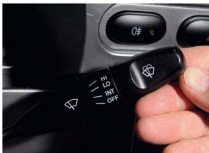
...перемещаем рычаг правого подрулевого переключателя в верхнее положение.
