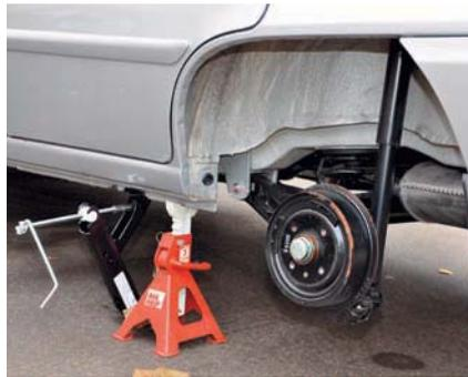
**Не работайте под автомобилем, если он вывешен только на домкрате. Для страховки используйте подставку заводского изготовления.**
