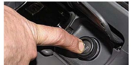
...нажимаем прикуриватель до срабатывания фиксатора.
