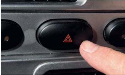
...нажимаем кнопку выключателя. Повторным нажатием кнопки выключаем аварийную сигнализацию.
