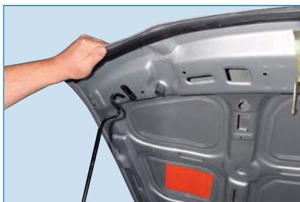
...и вставляем его в специальное отверстие в усилителе капота.
