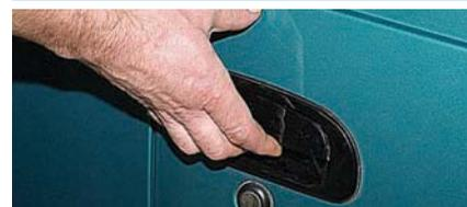
Чтобы открыть дверь снаружи, поднимаем ручку и тянем дверь на себя.
