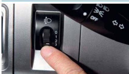
Регулируем направление световых пучков фар, вращая регулятор, расположенный на панели приборов слева.
