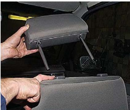
**...поднимаем его, одновременно нажимая кнопку фиксатора.**
