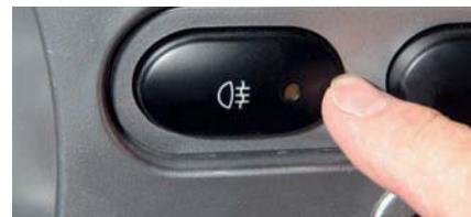
...при включенных передних противотуманных фарах нажимаем кнопку, расположенную в правой части панели приборов.
