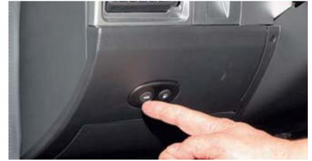
**...нажимаем кнопку открывания замка крышки багажника, расположенную над блоком предохранителей.**
