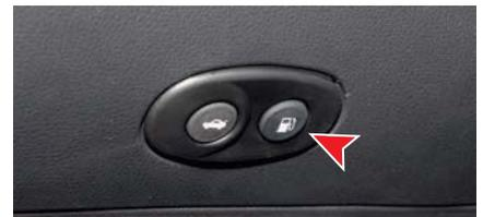
**...в салоне нажимаем кнопку открывания крышки лючка заливной горловины, расположенную рядом с кнопкой открывания замка крышки багажника.**
