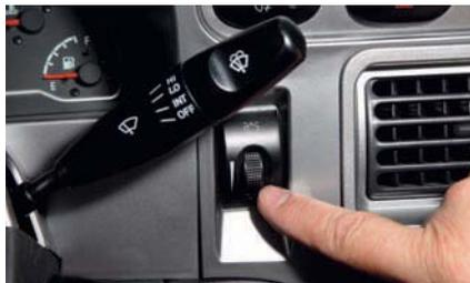
...изменяем длительность паузы между последовательными циклами работы стеклоочистителя.
