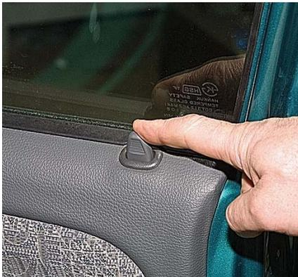
**...нажимаем кнопку блокировки замка на открытой двери...**
