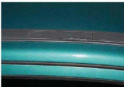
На крыше автомобиля имеются водосточные желобы с аэродинамическими накладками, в которых выполнены монтажные гнезда для установки багажника.
