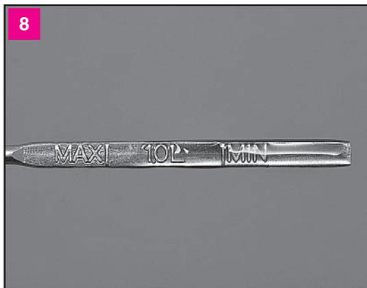
Уровень масла должен находиться между метками MAX и MIN, нанесенными на сплюснутую часть в нижнем конце щупа. Если уровень находится ниже метки MIN, доливаем масло небольшими порциями, чтобы не превысить максимальный уровень
