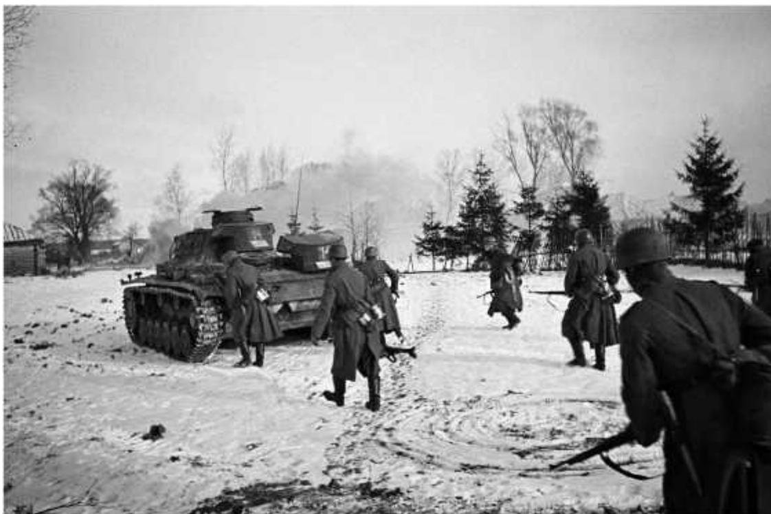
*Еще одно фото из серии, снятой в 11-й тд под Волоколамском. Обращает на себя внимание второй ящик для вещей (роммель-кисте) на корме первого танка, видимо, снятый с подбитого танка*
