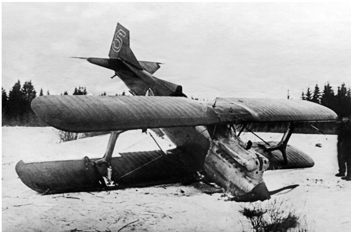
Аварийная посадка истребителя И-2 бис с 400-сильным мотором М-5. Длина – 7,32 м, размах крыльев – 10,8 м, площадь крыльев – 23,46 м<sup>2</sup>. Взлетный вес – 1575 кг. Максимальная скорость – 235 км/ч. Время набора высоты 3000 м – 9,6 мин. Время виража на высоте 1000 м – 16 с. Дальность полета – 600 км. Практический потолок – 5350 м. Вооружение – два пулемета калибра 7,62 мм
