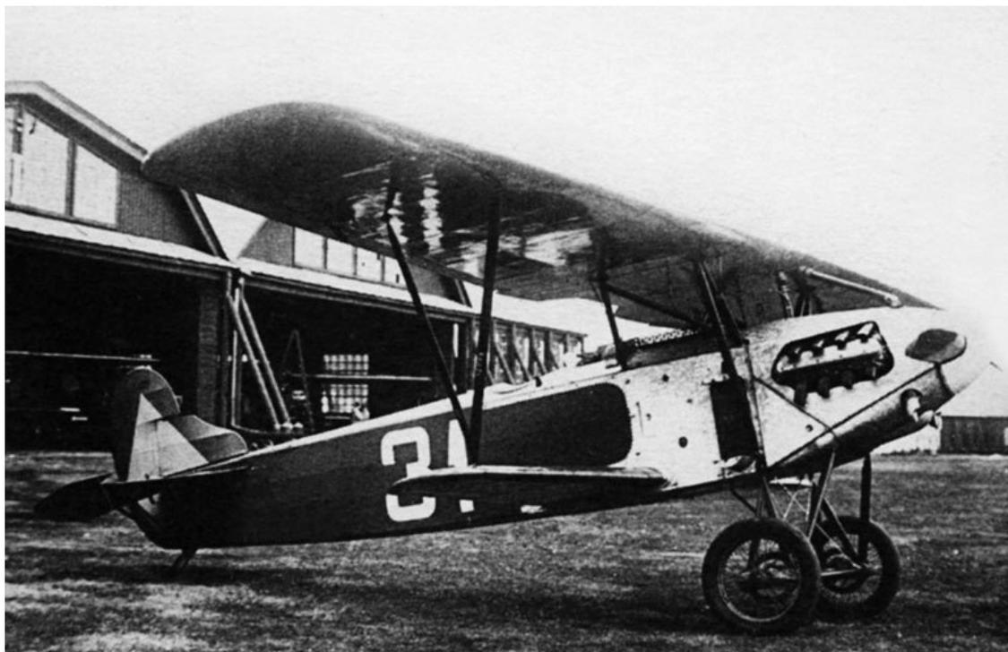
Истребитель «Фоккер» DХІІІ. Длина – 7,3 м, размах крыльев – 11,5 м, площадь крыльев – 21,8 м<sup>2</sup>. Вес пустого – 1120 кг, взлетный – 1250 кг. Максимальная скорость – 265 км/ч. Время набора высоты 1000 м – 1,75 мин. Дальность полета – 600 км. Практический потолок – 8000 м. Вооружение – два пулемета калибра 7,7 мм
