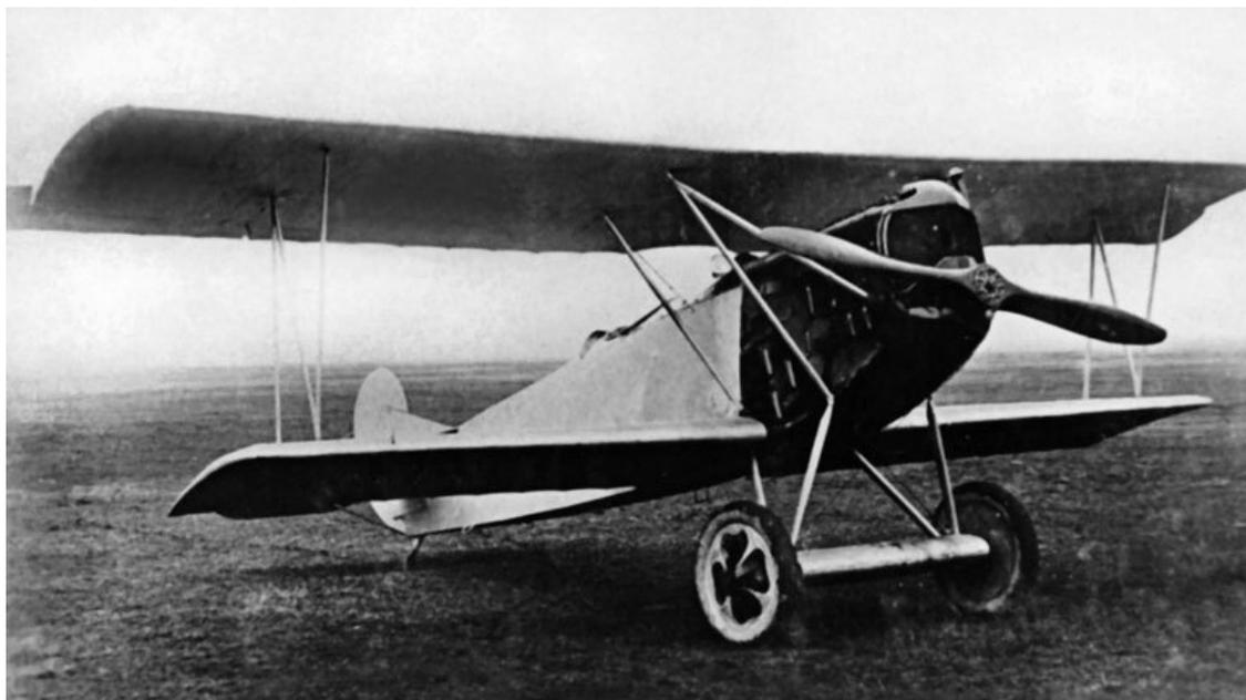
Истребитель «Фоккер» DVII с двигателем «Даймлер Ша» мощностью 200 л. с. Длина – 6,95 м, размах крыльев – 8,9 м, площадь крыльев – 20,2 (по другим данным – 20,5) м<sup>2</sup>. Вес пустого – 688 кг, взлетный – 906 кг. Максимальная скорость – 195 км/ч. Время набора высоты 1000 м – 1,75 минуты, 2000 м 6 минут 48 секунд (по другим данным – 4 минуты). Продолжительность полета – 1,5–2 часа. Практический потолок – 7000 м. Вооружение – два пулемета калибра 7,62 мм.
