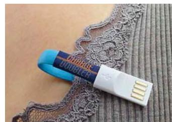
Кабель ChargerDoubler позволяет подзаряжать батареи гаджетов вдвое быстрее обычного. Этого эффекта удалось достичь благодаря тому, что он использует ток заряда 1000 мА вместо 500 мА, как обычные USB-кабели. Кроме того, ChargerDoubler способен блокировать передачу данных между ПК и мобильным гаджетом в целях безопасности. Длина кабеля составляет 6 см, его можно закрепить на брелоке с ключами посредством встроенного магнита. Стоимость аксессуара составит \$12.
