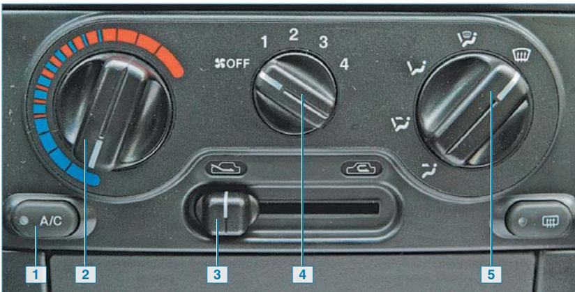
Блок управления отоплением, вентиляцией и кондиционированием: 1 — выключатель кондиционера; 2 — регулятор температуры воздуха; 3 — рычаг управления режимом рециркуляции воздуха; 4 — переключатель режимов работы вентилятора; 5 — регулятор распределения потоков воздуха
