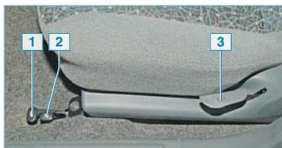
Расположение рычага 1 привода замка крышки багажника, рычага 2 привода замка крышки лючка заливной горловины топливного бака и рычага 3 регулировки наклона спинки переднего сиденья
