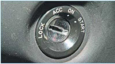
Ключ в замке зажигания может находиться в одном из четырех положений: «LOCK» — «блокировка»; «ACC» — потребители; «ON» — «зажигание»; «START» — «стартер»
