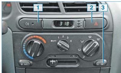
**Расположение выключателей на центральной консоли:** 1 — выключатель лампы противотуманного света в заднем фонаре; 2 — выключатель аварийной сигнализации; 3 — выключатель обогрева заднего стекла
