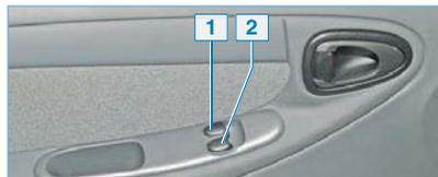
**Расположение выключателей электростеклоподъемников передних дверей на двери водителя:** 1 — клавиша выключателя стеклоподъемника двери водителя; 2 — клавиша выключателя стеклоподъемника передней правой двери
