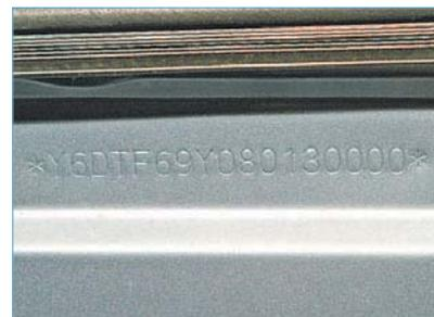
Идентификационный номер автомобиля (VIN) выбит на щитке передка рядом с электронным блоком управления двигателем (ЭБУ)
