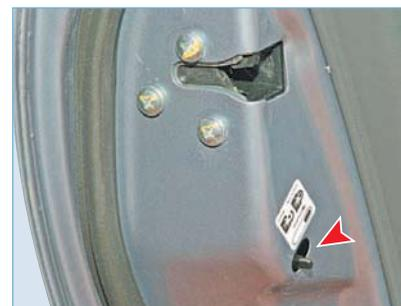
**Рычаг для блокировки внутренней ручки задней двери**
