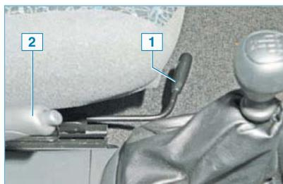
Расположение рычага 1 регулировки переднего сиденья в продольном направлении и рычага 2 стояночного тормоза
