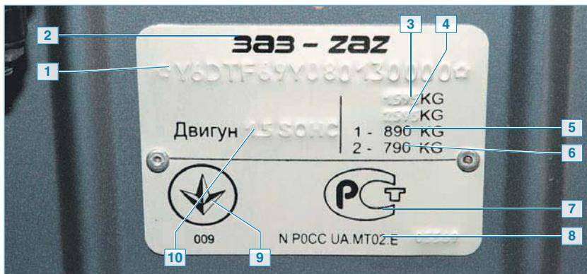
Расшифровка обозначений в табличке: 1 — идентификационный номер (VIN); 2 — товарный знак завода-изготовителя; 3 — разрешенная максимальная масса автомобиля, кг; 4 — разрешенная масса автомобиля с прицепом, оборудованным тормозами; 5 — максимально допустимая нагрузка на переднюю ось, кг; 6 — максимально допустимая нагрузка на заднюю ось, кг; 7 — знак соответствия; 8 — номер «Одобрения типа транспортного средства России»; 9 — национальный знак соответствия ДСТУ 2296; 10 — тип двигателя
