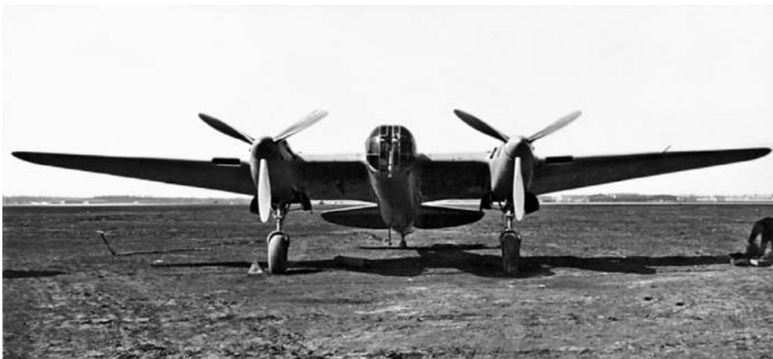
На виде спереди в крыле видны заборники воздуха для водорадиатора, расположенного в крыле
