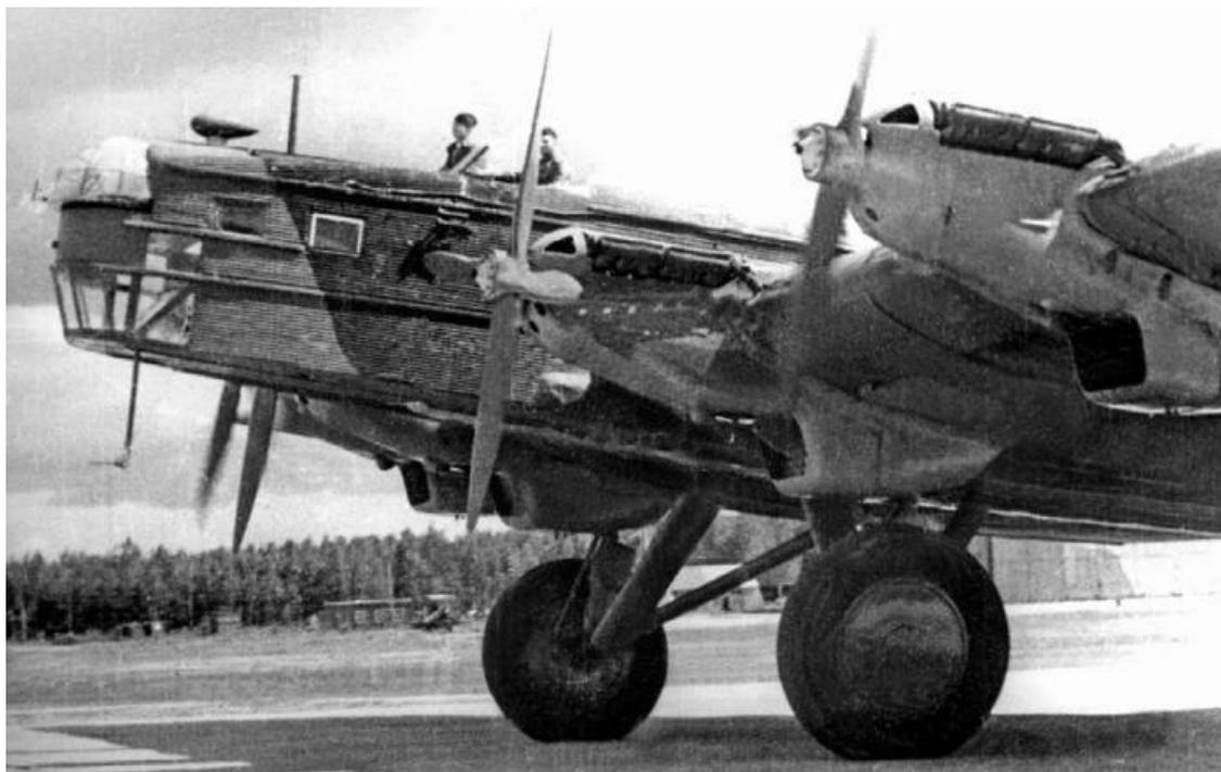
*ТБ-3РН в НИИ ВВС с двигателями М-34РН и одноколесными основными опорами шасси. На фюзеляже за носовой стрелковой установкой виден каплеобразный обтекатель антенны радиокompаса*
