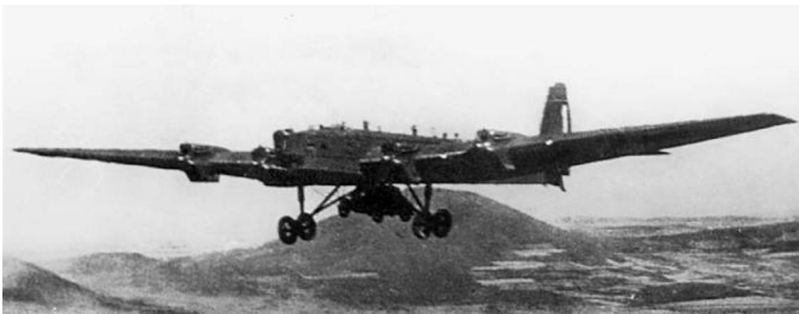
*Транспортировка броневедомола на внешней подвеске ТБ-3 с моторами М-17*
