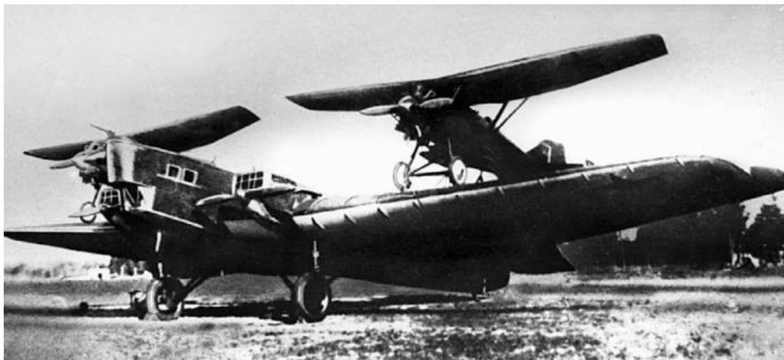
*«Звено-2» В.С. Вахмистрова. На крыле ТБ-1 расположились два истребителя И-4 со снятыми нижними крыльями*
