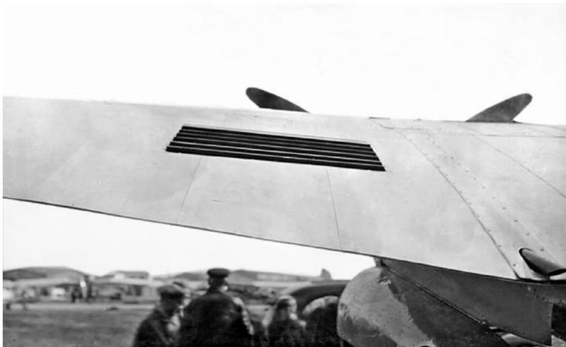
*Щели для выхода теплого воздуха из системы охлаждения двигателей располагались на внешней поверхности крыла*
