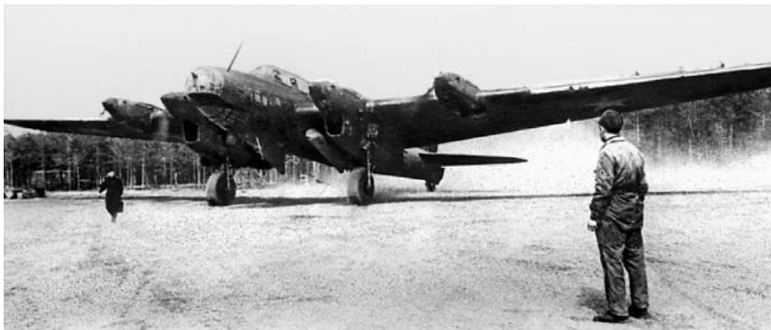
*Пе-8 с двигателями АМ-35А и выливными приборами ВАП под крылом вырывается на взлет*
