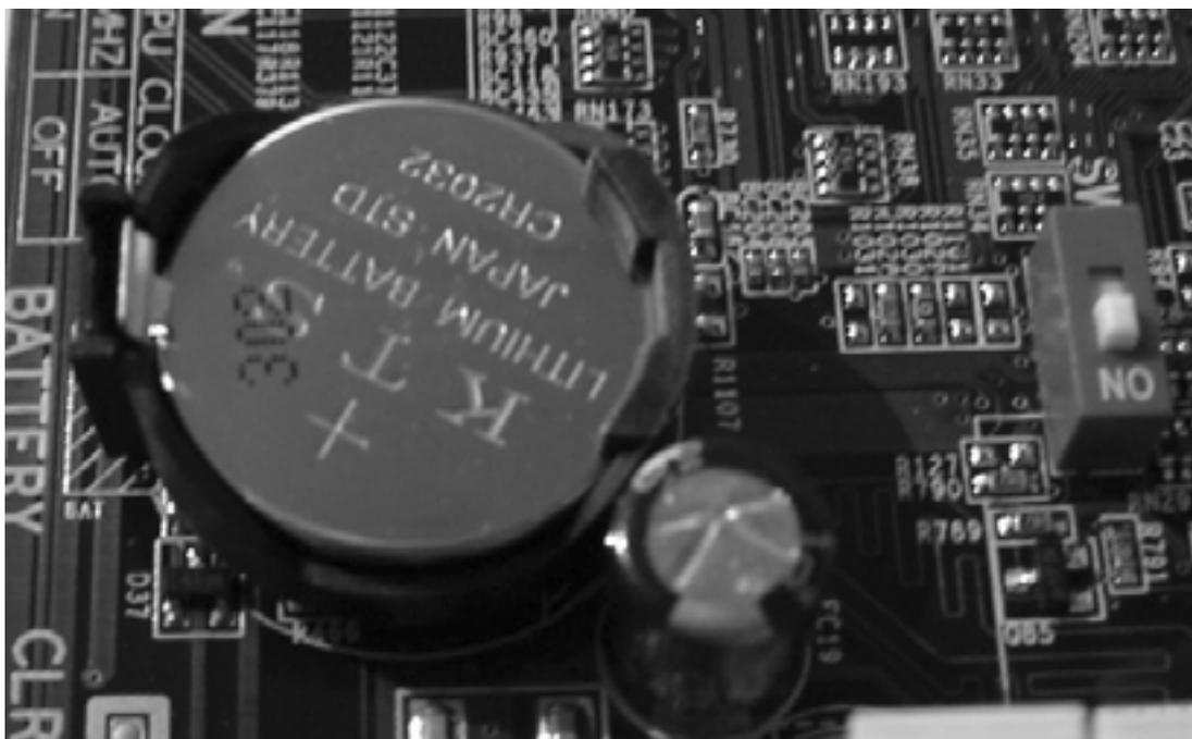
Рис. 1.2. Секрет «энергонезависимой» CMOS памяти заключается в этом аккумуляторе
