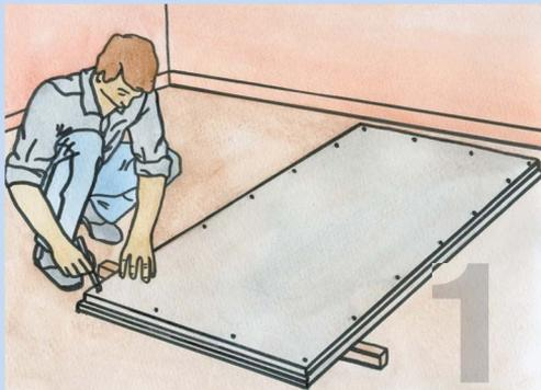
Для того чтобы укрепить щитовую дверь, вам понадобятся листы жести толщиной 1,5–2 мм. Предварительно снимите с дверного полотна всю фурнитуру и положите его на пол внешней стороной вверх. Разметьте расположение крепежных отверстий и просверлите их.
