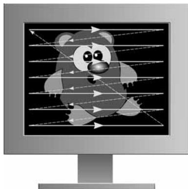
**Рис. 2.1.** Развёртка изображения на экране монитора
