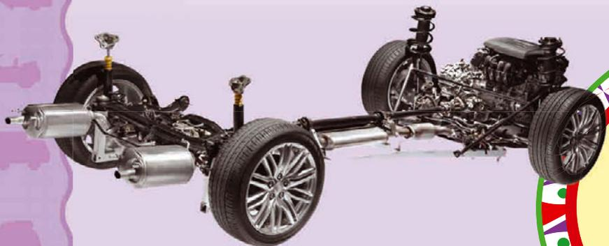
Колесо состоит из прочного металлического диска, на который надета резиновая шина. Бороздки на шине позволяют лучше цепляться за асфальт, а шипы – за лёд.
