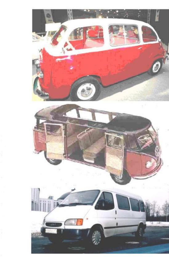
Компановка автомобилей позволяет располагать внутри него не только пассажирский отсек, но и двигатель и элементы шасси автомобилей, что очень важно для легковых автомобилей и позволяет сделать сверхкомпактные автомобили с комфортным кузовом, которые относятся к классу компакт» и нашли очень широкое применение в настоящее время.
