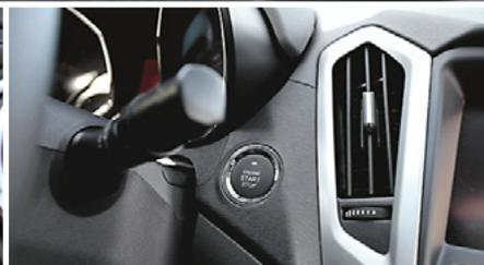
▲ Уже в базовой комплектации Arrizo 7 двигатель запускается кнопкой, а ключ — бесконтактный
