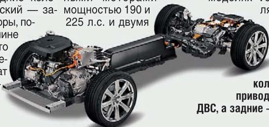
Передние колеса XC90 будет приводить в движение ДВС, а задние — электромотор
