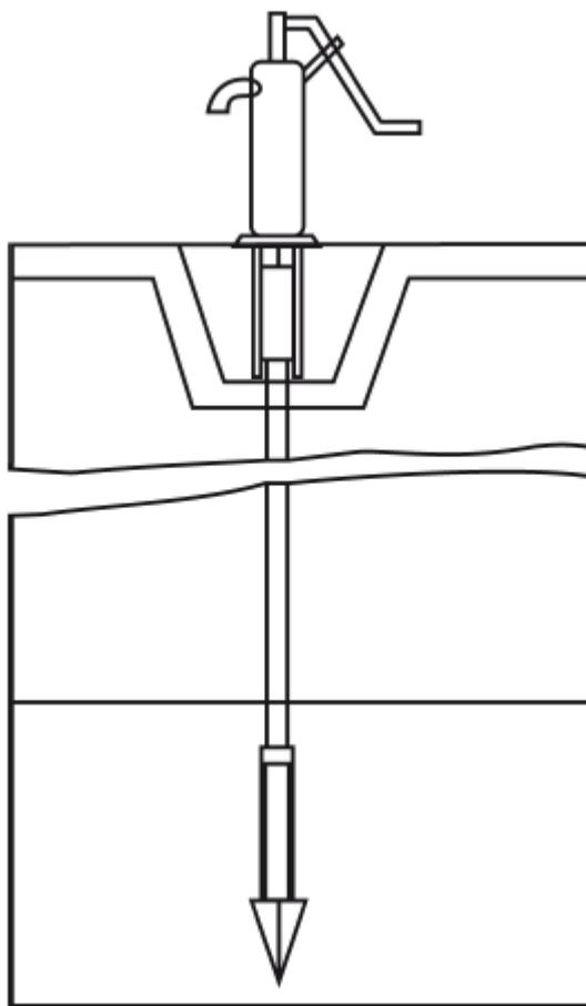
Рисунок 8. Абиссинский трубчатый колодец
