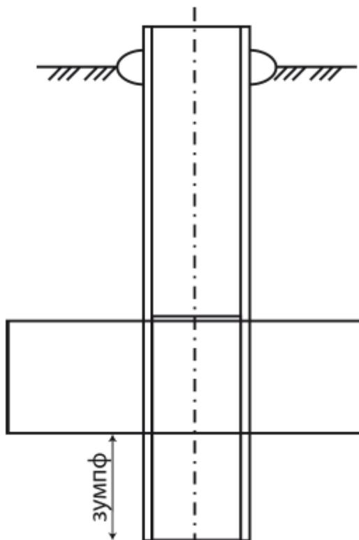
Рисунок 3. Устройство совершенного шахтного колодца с зумпфом
