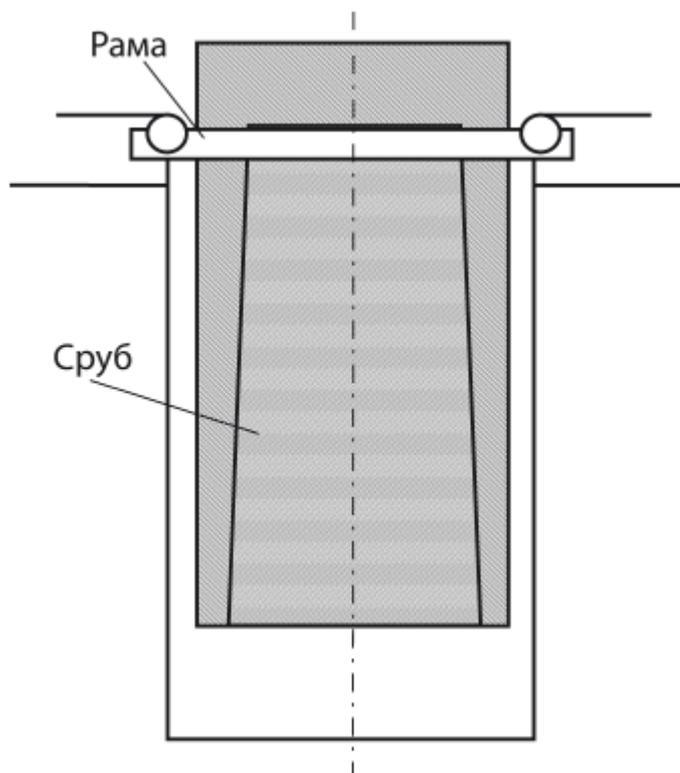
Рисунок 5. Сруб, находящийся в шахте на канатах
