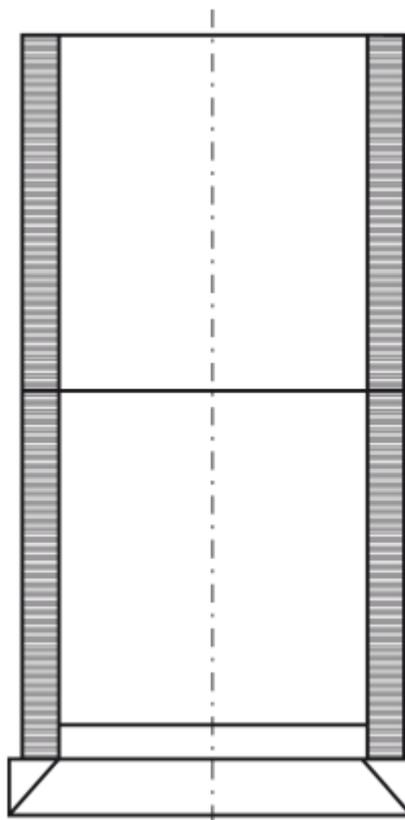
Рисунок 6. Крепление из бетонных колец впритык
