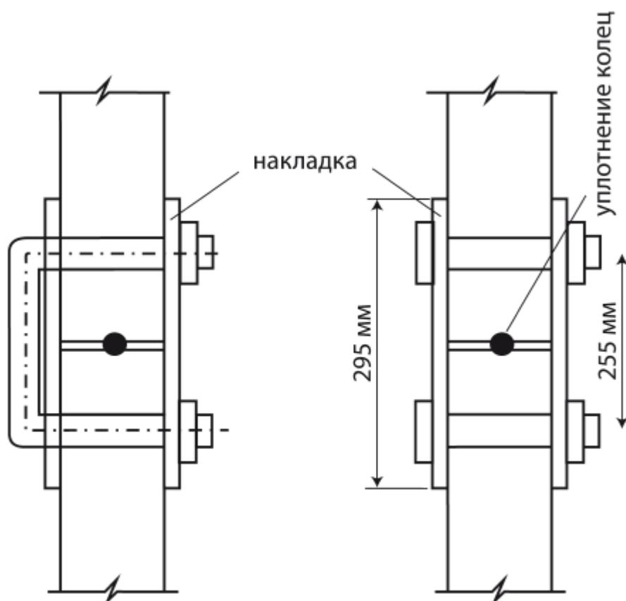
Рисунок 7. Соединение бетонных колец
