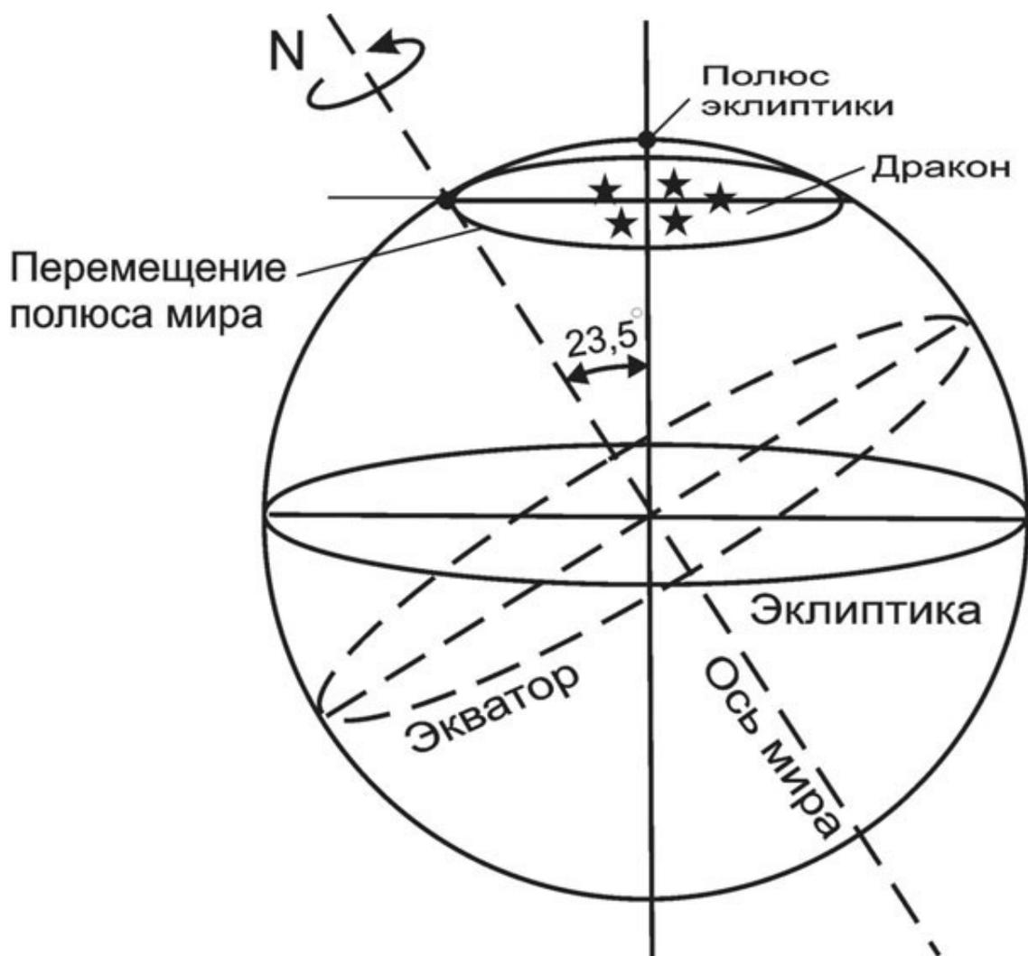
Рис. 3.1. Прецессия полярной оси.
