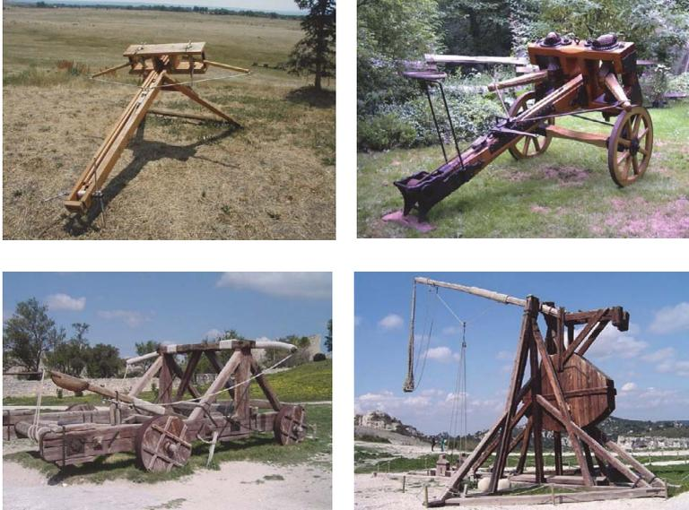
**Рис. 1.1.** Древние метательные машины: 1 — баллиста, 2 — арбалет, (эфтитон, скорпион), 3 — катапульта, 4 — требушет (фрондибола)<sup>5</sup>
