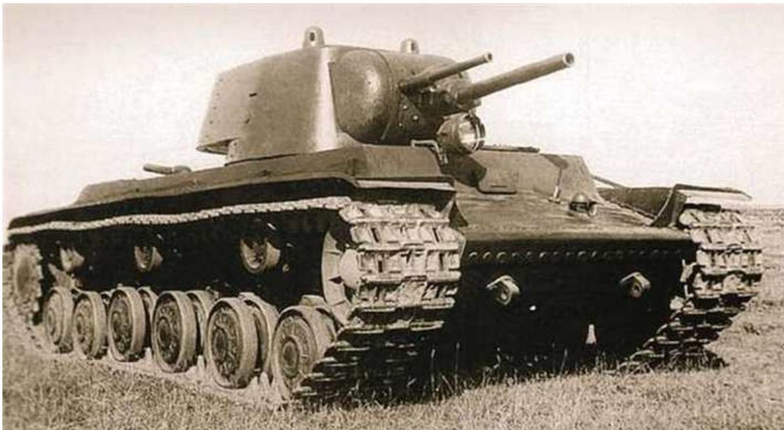
Первый опытный образец тяжелого танка КВ (У-0) перед отправкой в Москву. Сентябрь 1939 г. В башне танка смонтированы два орудия – 45-мм и 76-мм. В декабре 1939 г., перед отправкой У-0 в 20-ю тяжелую танковую бригаду, 45-мм орудие было снято
