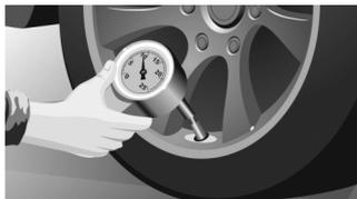
**Рис. 11.** Проверка давления в шинах манометром
